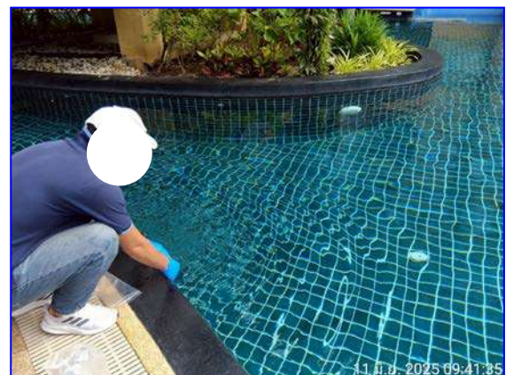
รูปที่ 3.3 แสดงการเก็บตัวอย่างน้ำสระว่ายน้ำ (จุดลึกและจุดตื้น)
