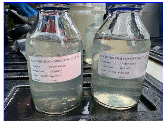
รูปที่ 3.2 แสดงการเก็บตัวอย่างน้ำผ่านการบำบัด (ประตูทางออก)
